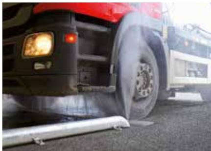
Sistema de alta presión para el lavado de bajos al paso a **70 bar y 126 L/min**. Se instala en el principio de la pista de lavado y dispone de fotocélulas de entrada para su accionamiento automático y de **12 boquillas rotantes de ángulo cero**. Puede trabajar con el mismo rack de bombas de alta presión que alimenta el puente mediante una electroválvula de conexión.
