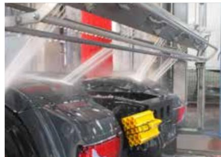
Especialmente desarrollado para el lavado sin cepillos de las partes frontales y superiores de los vehículos o para perfeccionar los resultados de lavado de las flotas más exigentes. Trabaja con **16 boquillas de ángulo cero a 70 bar y 126 L/min.** y con un motor de oscilación y otro de giro que permite un movimiento de **180° controlado por programa.**
