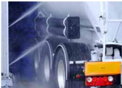
El opcional perfecto para complementar el lavado con cepillos en la parte inferior de los vehículos o en aquellos rincones en los que éstos no pueden entrar como son las llantas, el chasis inferior o los depósitos. Se compone de **16 boquillas de ángulo cero** para lavar a **70 bar y 84 L/min. o 126 L/min.**, trabaja con un motor de oscilación (arriba-abajo) y un cilindro de rotación (delante-detrás) para limpiar profundamente esta área desde diferentes ángulos.
