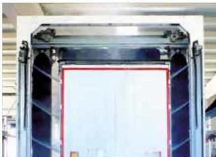
Recomendado para lavar con profundidad la parte lateral superior de los vehículos, en especial camiones cisterna o de basura o de perfiles especiales, y alcanzar así aquellas zonas en las que los cepillos verticales no pueden lavar. Compuesto por **24 boquillas de ángulo cero** para lavar a **70 bar y 126 L/min.**, trabaja con un motor de oscilación (arriba-abajo) y un cilindro de rotación (delante-detrás).
