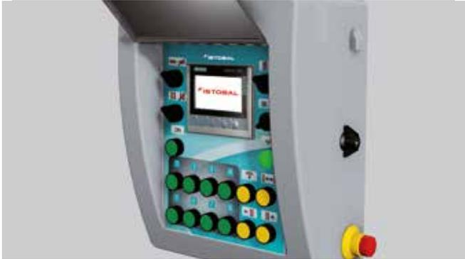
El puesto de mando exterior con pantalla táctil a color permite una **navegación fácil e intuitiva** por el menú de la máquina. Dispone de pulsadores para el movimiento manual de la máquina y de los cepillos y selección de hasta 15 programas con la posibilidad de conexión online para un control remoto. La configuración flexible permite ajustar los programas por pasada de lavado, optimizando las velocidades de cada una de ellas.
