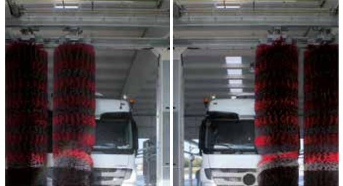
Cepillos verticales autopropulsados que permiten el doble fregado en la parte delantera y trasera de los vehículos. La posición de los cepillos de polietileno de alta densidad se controla mediante encoder y opcionalmente disponen de inclinación frontal patentada, lo que permite mejorar el lavado del parabrisas frontal de los vehículos.
